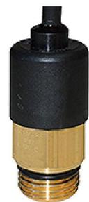
Termostato di sicurezza a taratura fissa di 50°C. Attacco 1/2" maschio. NC. 10(1)A/250 VAC. Temperatura massima: 120°C, pressione massima 80 bar.
