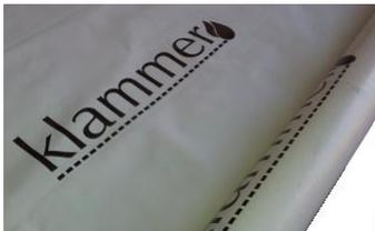
Da utilizzare come **barriera vapore** sopra le lastre di isolamento e la rete. Spessore 0,2mm, larghezza 1 metro si apre a 4 metri di larghezza totale.
