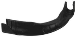
**Curva guida tubo a 90°** in materiale plastico. Adatte per il montaggio sotto ai collettori nelle partenze dei circuiti per un corretto posizionamento delle tubazioni. Aperte da un lato per un facile montaggio.
