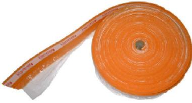
**Fascia perimetrale** di dilatazione in polietilene espanso, totalmente adesiva, colore arancione di spessore 8 mm. – Altezza 150 mm. – Densità 22 kg/mc. con foglio in LD per impedire infiltrazioni di cemento tra pareti e pannelli. Confezionata in rotoli da 50 mt.
