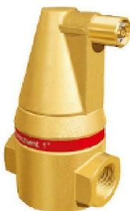
I **separatori d'aria** Flamcovent sono ideati per impianti di riscaldamento o raffreddamento a circuito chiuso con temperatura massima dell'acqua di 120°C e pressione massima di 10 bar. Con attacco filettato da 1" e 1 1/4", nei separatori d'aria Flamcovent è alloggiato un grande numero di anelli PALL. Grazie a questo sistema è possibile eliminare dall'acqua anche le microbolle più piccole.
