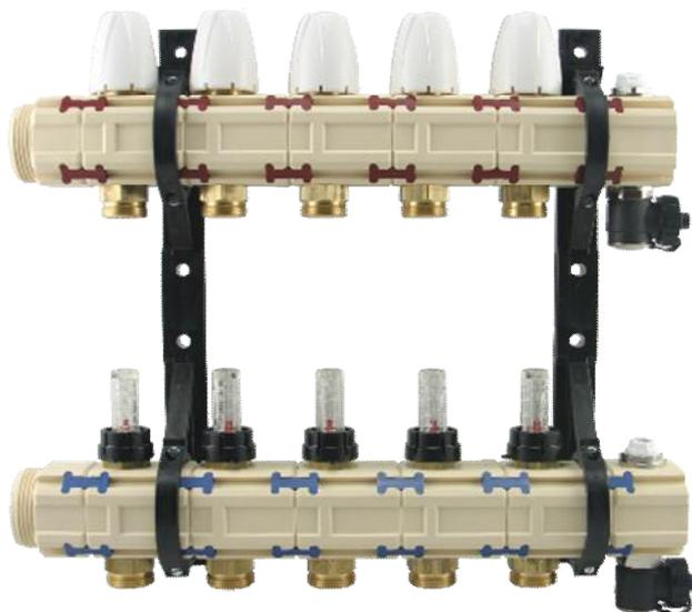
Collettori per BASSA temperatura in POLIMERO dn 1 ¼, con attacco filetto m d. 1 ½ completo di : staffe, 2 valvole di sfiato manuali, 2 rubinetti di scarico impianto, tappo terminale, detentori di chiusura e regolazione, valvole a volantino predisposte per il montaggio di attuatori termici.
